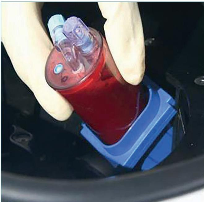
**Figura 2.** Il sangue con apposita cartuccia contenitore viene centrifugato attraverso il dispositivo dedicato Res-Q™ CentrifugeCesca-Therapeutics™.
